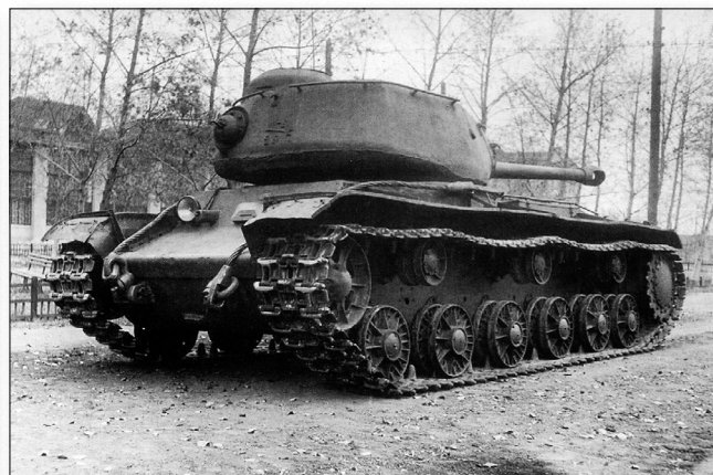
Танк KB-122 со 122мм пушкой Д-25Т (второй вариант дульного тормоза), общий вид. Челябинск, завод №100, весна 1944 года.
