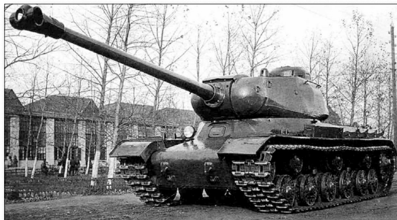
Эталонный образец танка ИС-122 («Объект 240»), вооруженный 122мм пушкой Д-25Т (А-19 «танковая»). 1943 год, октябрь.
